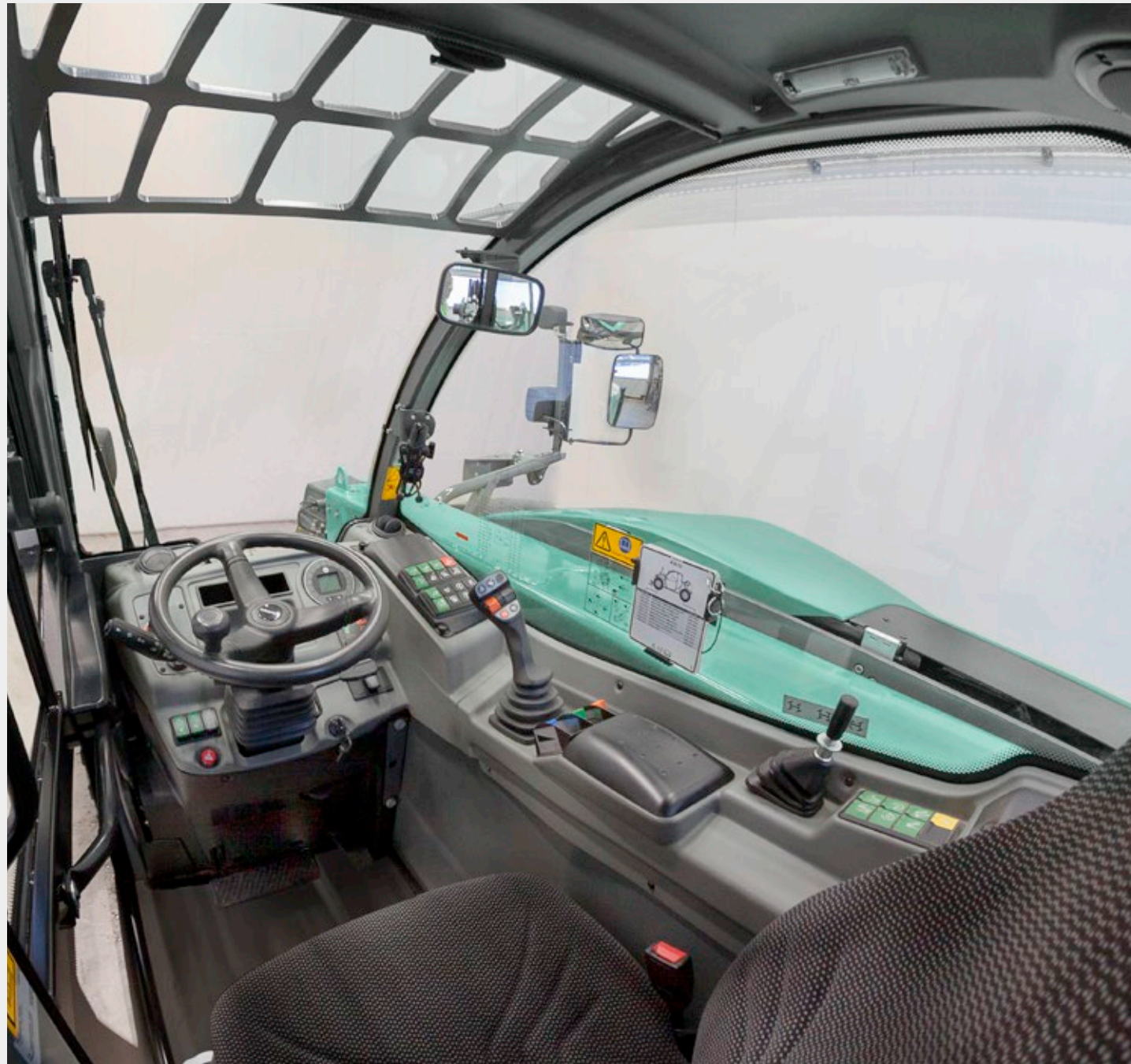
Dobra widoczność w prawo ze względu na dużą szybę i niskie położenie wysięgnika teleskopowego
