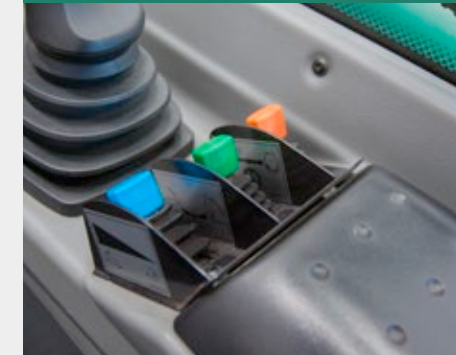
Tempomat niskich prędkości jazdy / gaz ręczny
