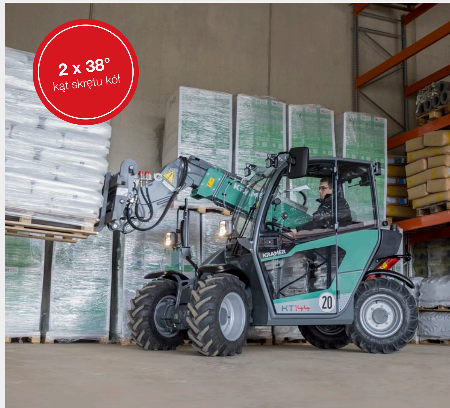
Tryb kierowania na wszystkie koła: szczególnie duża zwrotność w ciasnych miejscach
